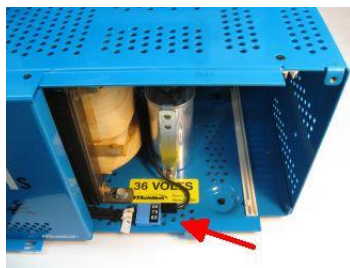
Fig. 7-1 Posición de voltaje de salida conector selección
