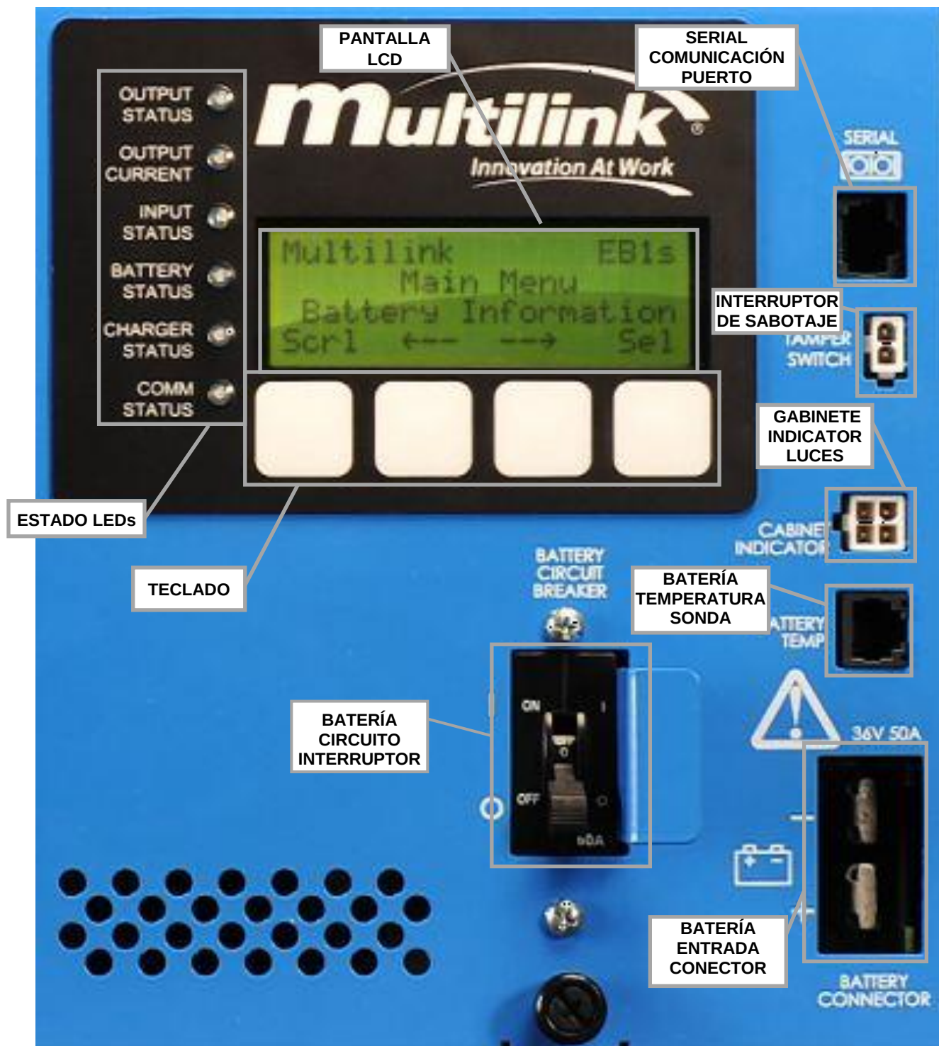
Fig. 3-1 Detalle de Fuente de Alimentación Panel Frontal
